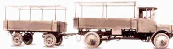
1923 rüstete Knorr-Bremse als erstes Unternehmen in Europa Lastkraftwagen mit Vierrad-Druckluftbremsen aus
