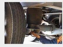
Top bolt nuts – 40Nm Bottom bolt nut – 80Nm
